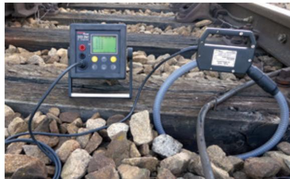
Kein Gleisstromkreisstrom über dem elektrischen Trennstoß
