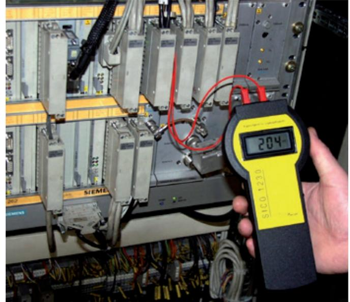
Das Abgleichgerät für Zugkoppelspulen **SICO 1230** ist für Spannungsmessungen zum Abgleich von ZUB-Fahrzeugkoppelspulen im Frequenzbereich von 50 ... 100 kHz geeignet. Mit dem Gerät können speziell die Fahrzeugkoppelspulen mit einer Trägerfrequenz von 100 kHz und des 50 kHz-Kreises der Systeme ZUB 100 und ZUB 200 abgeglichen werden.
