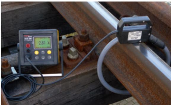
Fehlersuche, Abnahme-/ Umbauprüfung und Inspektion an Gleisstromkreise
