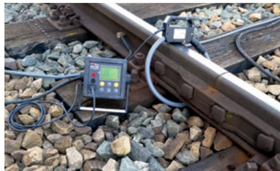
Gleisstromkreis-Fehlerstrom über dem Isolierstoß
