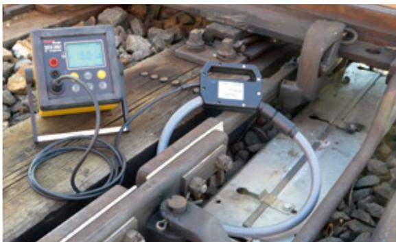
Gleisstromkreis-Fehlerstrom über der Schieberstange
