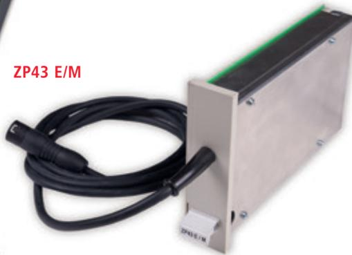
Der Zählpunktadapter **ZP43 E/M** wird für den Anschluss des Prüfgeräts für Siemens Gleisstromkreise und Achszähler **SICO 2056 PEGA** an die Zählpunkte ZP43 E und ZP43 M genutzt.
