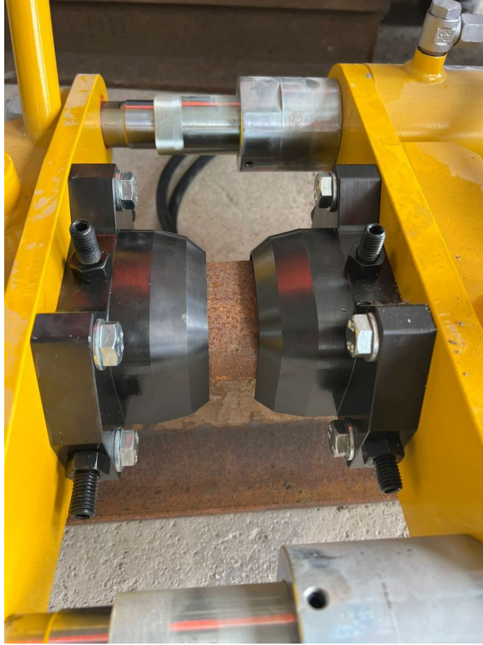
Kaynak sıyırma bıçağı uygulama görünümü - hidrolik makine üzerinde
