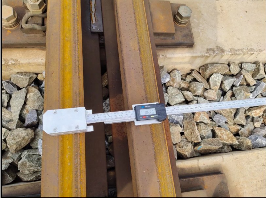
Makas bölgesinde açıklık ve ofset ölçümü için örnek yerleşim.
