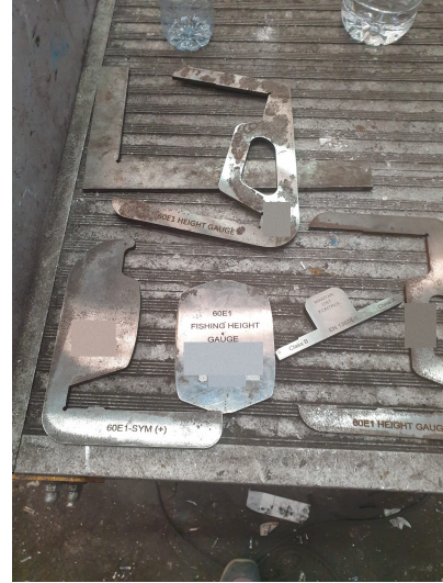
Mantar, yükseklik, asimetri ve fishing height mastar örnekleri
