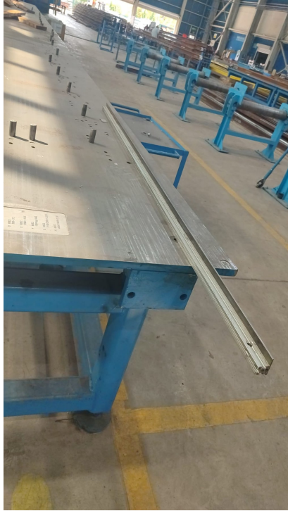
R300 m örnek master: Belirli bir kurp yarıçapına göre hazırlanmış kontrol masterı.
