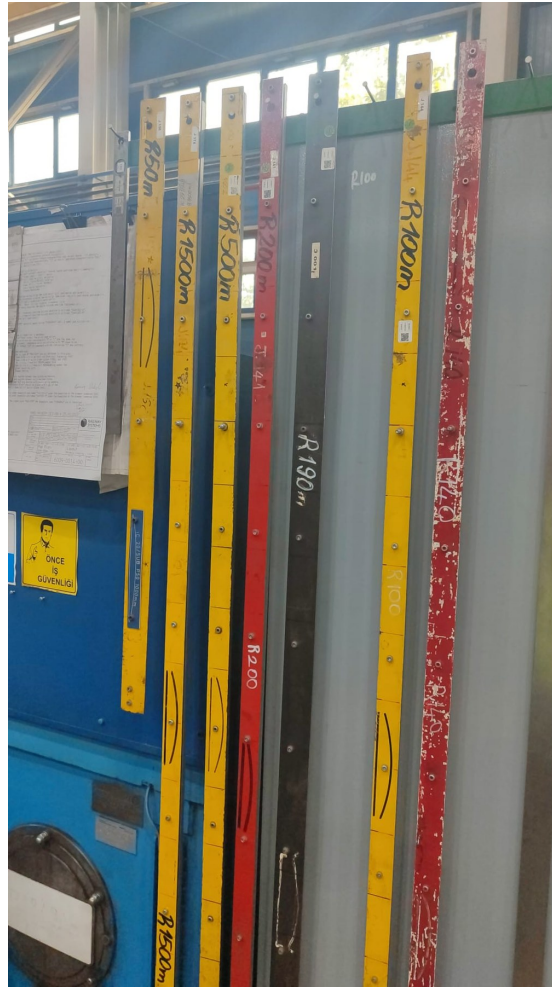
Farklı yarıçaplara göre hazırlanmış ray kontrol masterları - R100 m, R190 m, R200 m, R300 m, R1000 m, R1500 m vb.
