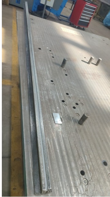
Alüminyum/profil referanslı uzun master uygulaması: ray boyunca doğrultu ve geometri kontrolü.
