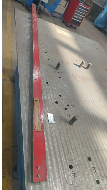
Masterın kontrol tablası üzerinde konumlandırılması: Ray/radyus doğruluğu için referans master kullanımı.
