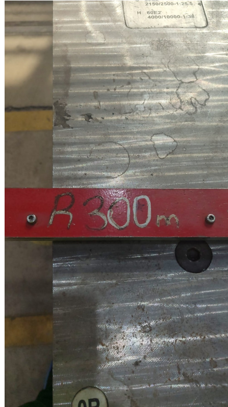
Farklı R değerlerine sahip master seti: farklı kurp yarıçapları için ayrı kontrol masterı kullanılır.
