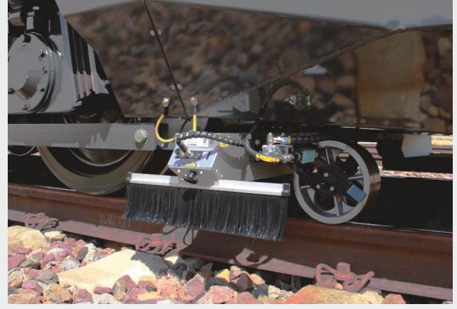
Entegre lazer tabanlı enine profil ölçüm sistemi
