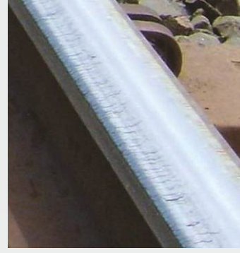
Ray yüzeyinde RCF ve yazılımda haritalanması
