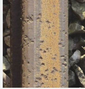
Ray yüzeyinde çukurlaşma ve yazılımda haritalanması
